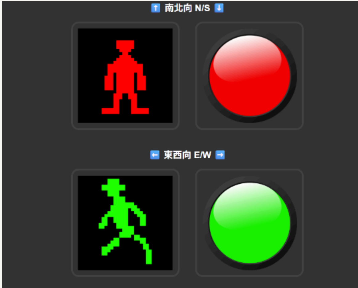
圖三、對號誌控制器下指令並透過 WebSocket輸出燈號
